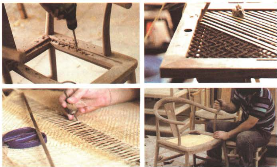
图9-27 椅子藤屉结构的编织过程 (图片来源:木智工坊的微博)
