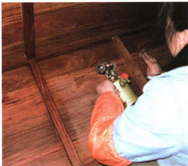
图10-4 匠师在给顶箱柜内部烫蜡
