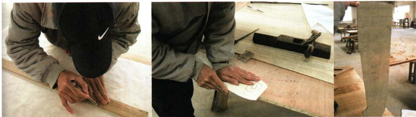
图6-3 罗汉床内翻马蹄足构件样板的制作
