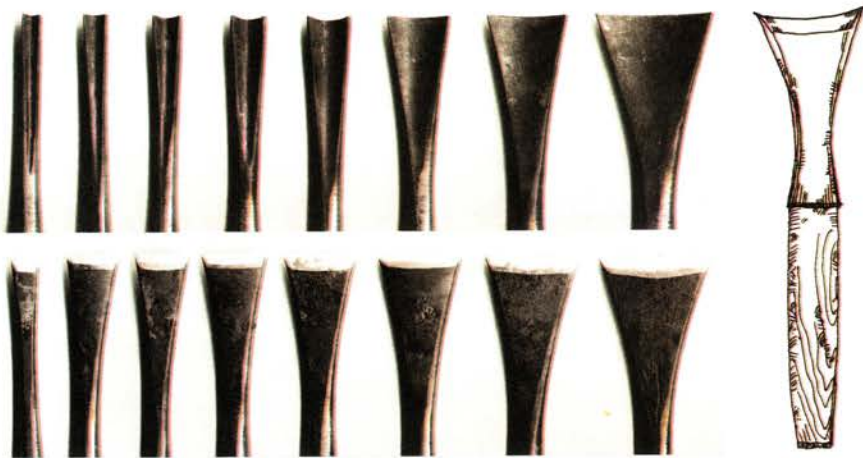
图5-35 圆凿主要型号排列图
